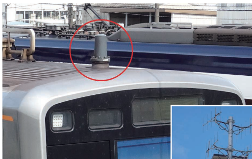
車上設備 アンテナ
